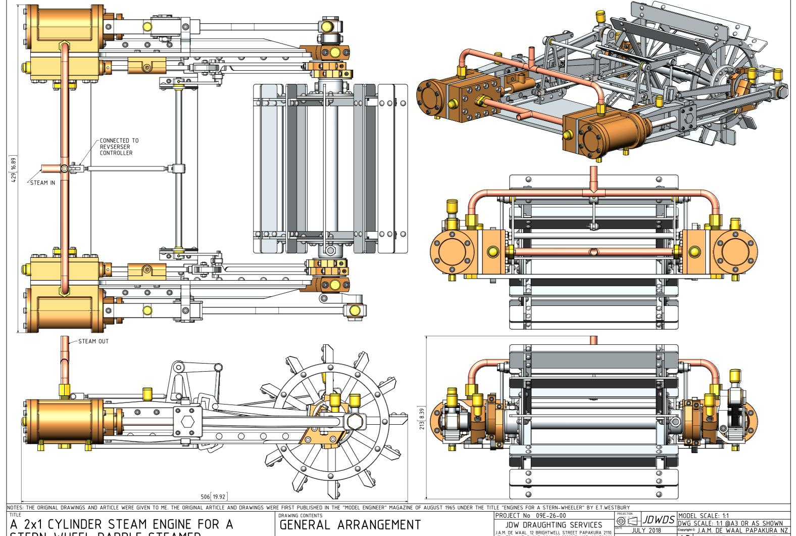
A 2x1 CYLINDER STEAM ENGINE FOR A STERN-WHEEL PADDLE STEAMER
