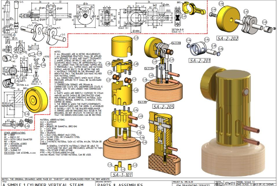
A SIMPLE 1 CYLINDER VERTICAL STEAM ENGINE 12mm BORE x 12mm STROKE
